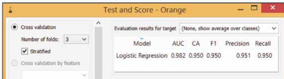
Рис. 4. Результат перекрестной проверки алгоритма логистической регрессии Fig. 4. The result of cross-validation of the logistic regression algorithm
