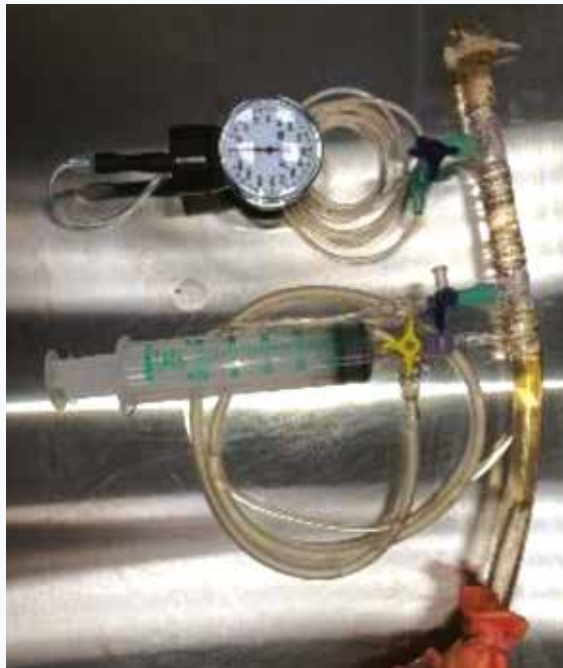
Рис. 3. Стенд для проведения водяной пробы Fig. 3. A device for performing the water test
